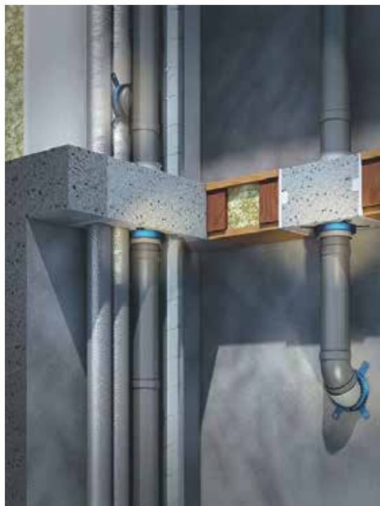
EINBAUSITUATION CURAFLAM® XS PRO von Doyma in Holzbalkendecke
