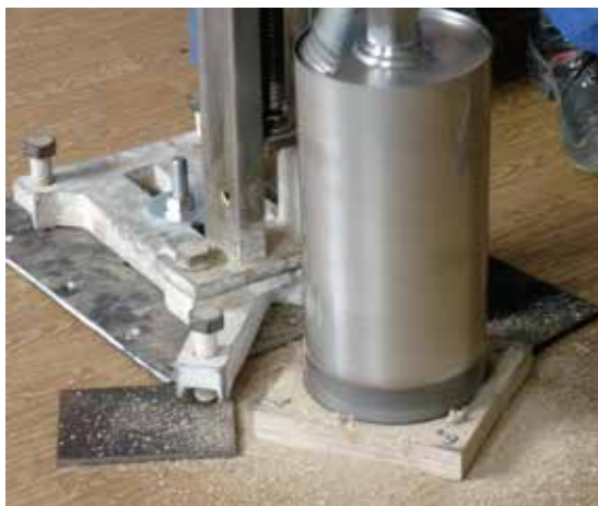
DER DECKENSTANZER. Die Laschen dienen der Sicherung am Bohrgerät.
