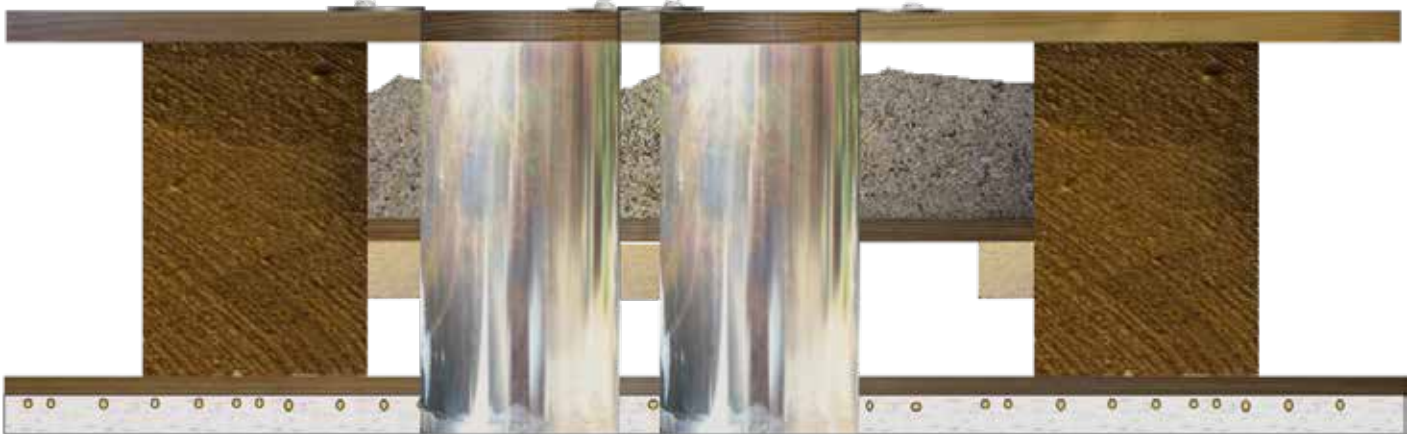
SYSTEMSKIZZE Querschnitt Holzbalkendecke mit zwei Deckenstanzer-Durchführungen
