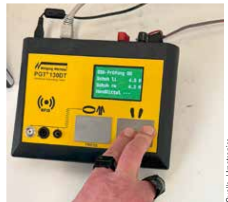
2 Verpflichtende Eingangskontrolle mit einem ESD-Testgerät vor dem Betreten der Fertigung
