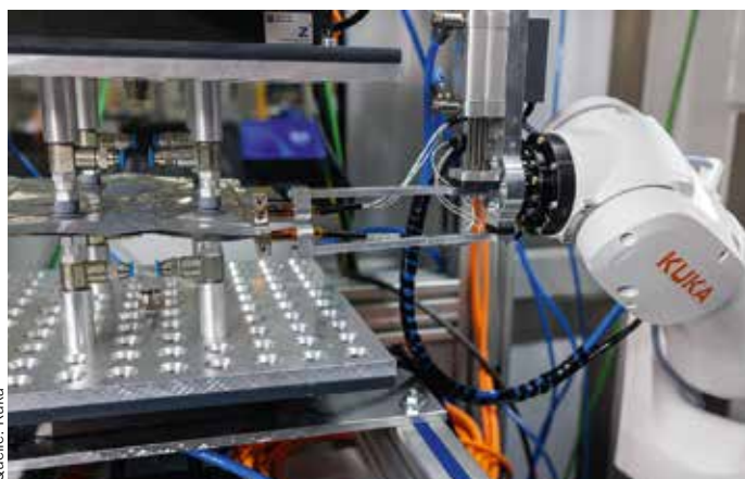
2 Der Roboter arbeitet im Mini-Environment rund um die Uhr und sorgt im Gegensatz zu einer menschlichen Arbeitskraft dafür, dass die Luft trocken bleibt
